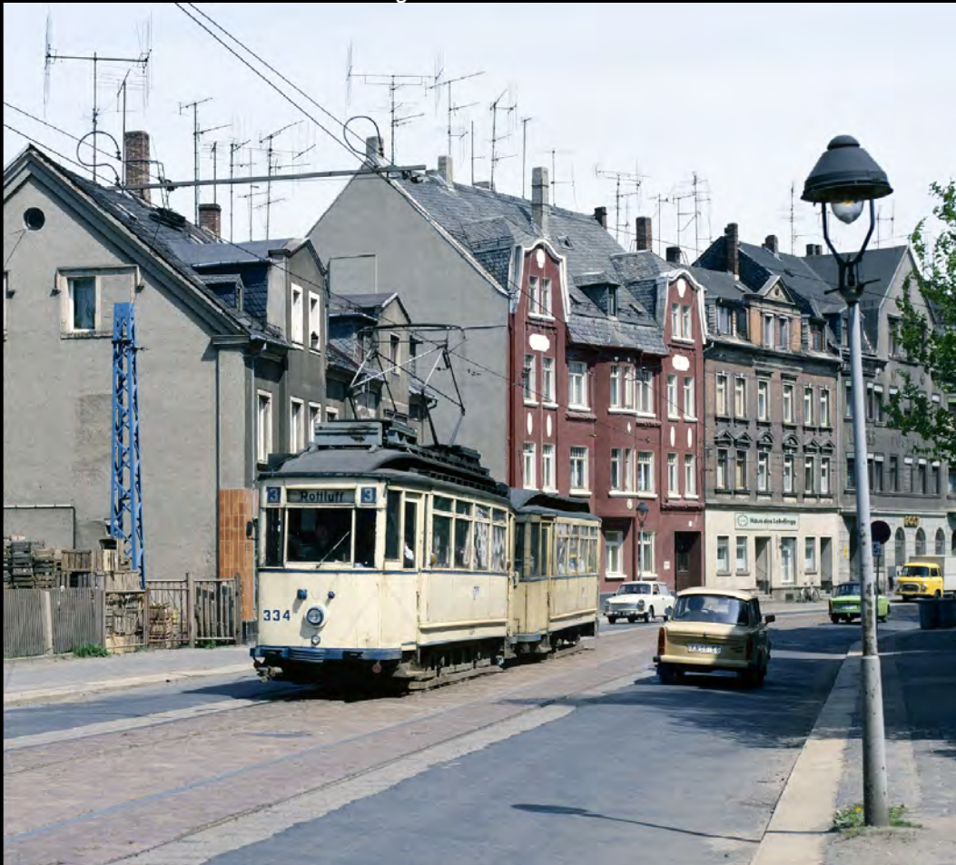
Oben: Die Kaßbergauffahrt um 1910 mit Gaskandelabern, die übliche Chemnitzer Variante. Darauf Ritter-Rundmantellaternen mit stehendem Gasglühlicht. Unten eine Leistner-Gasauflatzleuchte auf Stahlkandelaber (1988) in der Limbacher Straße, die Straßenbahnlinie 3 auf dem Weg nach Rottluff. Die Linie fuhr auf 925mm Spur und wurde am 6. November 1988 eingestellt. Bemerkenswert auch der Antennenwald. Bild Bodo Schulz
