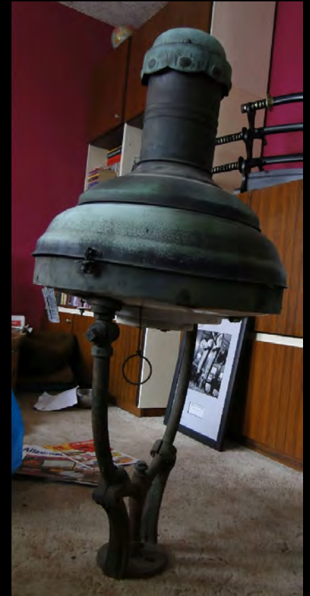
Die RECH-Gasleuchte „Modell Frankfurt“. Ihre Höhe beträgt vom Sockel bis zum Dach etwa 110 cm.
