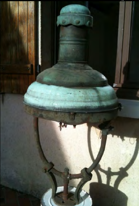
Die RECH-Gasleuchte „Modell Frankfurt“. Ihre Höhe beträgt vom Sockel bis zum Dach etwa 110 cm.
