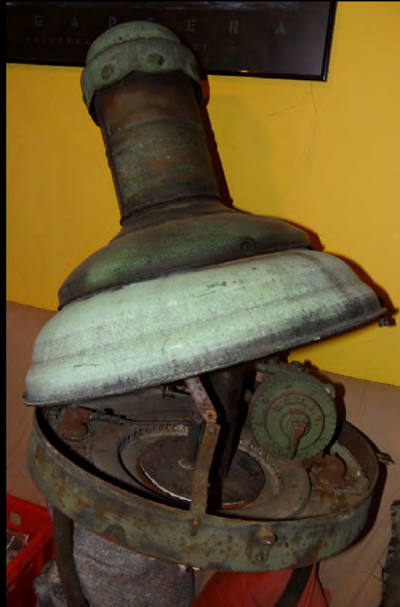
Die RECH-Gasleuchte „Modell Frankfurt“. Ihre Höhe beträgt vom Sockel bis zum Dach etwa 110 cm.
